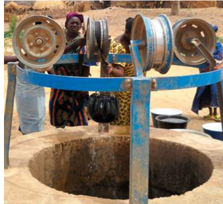
Equipement d'exhaure, puits Niger
